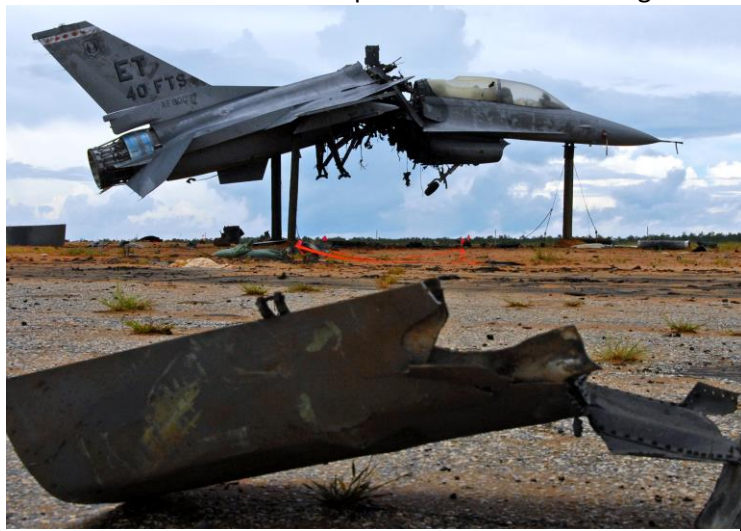
Photographie peu courante d'un F-16, brisé à la suite d'un test du système de terminaison de vol, sur une base de l'US Air Force en Floride (crédit : U.S. Air Force photo/Samuel King Jr. )
