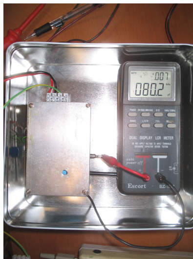
Figure 10-11 : Etalonnage des condensateurs de transfert d'étalon de capacité par le biais d'un capacimètre numérique
