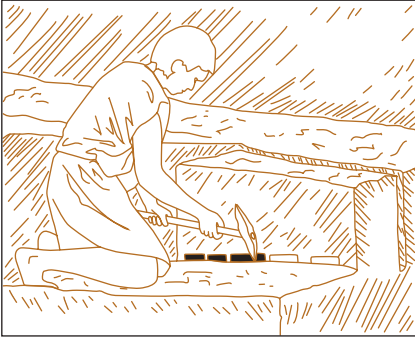
Creusement d'emboitures au mortaisoir d'après J.-C. Bessac. Déchets d'abattage et front de taille avec emplacements des trous de coins dans les mines de Meurin (Eifel, Allemagne). Photos K. Bausier.
