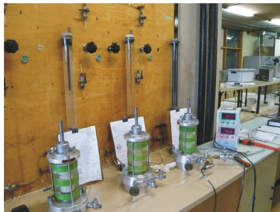
Saturation et consolidation des échantillons + boîtier de lecture des pressions appliquées
