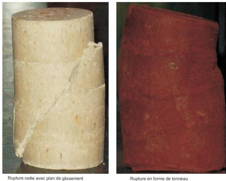
Figure VII.23 : Déformation des échantillons E-01 et E-02 après essais triaxiaux à succion non contrôlée (rupture nette pour E-01 avec plan de glissement et rupture en forme de tonneau pour E-02 sans plan de glissement)
