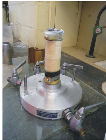
Cylindre de sol emballé dans un papier filtre et protégé par une membrane en caoutchouc placé sur le socle de la cellule
