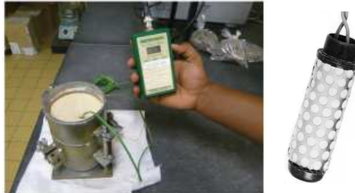
Figure VII.15 : Mise en place de l'essai watermark, boîtier de lecture et sonde watermark
