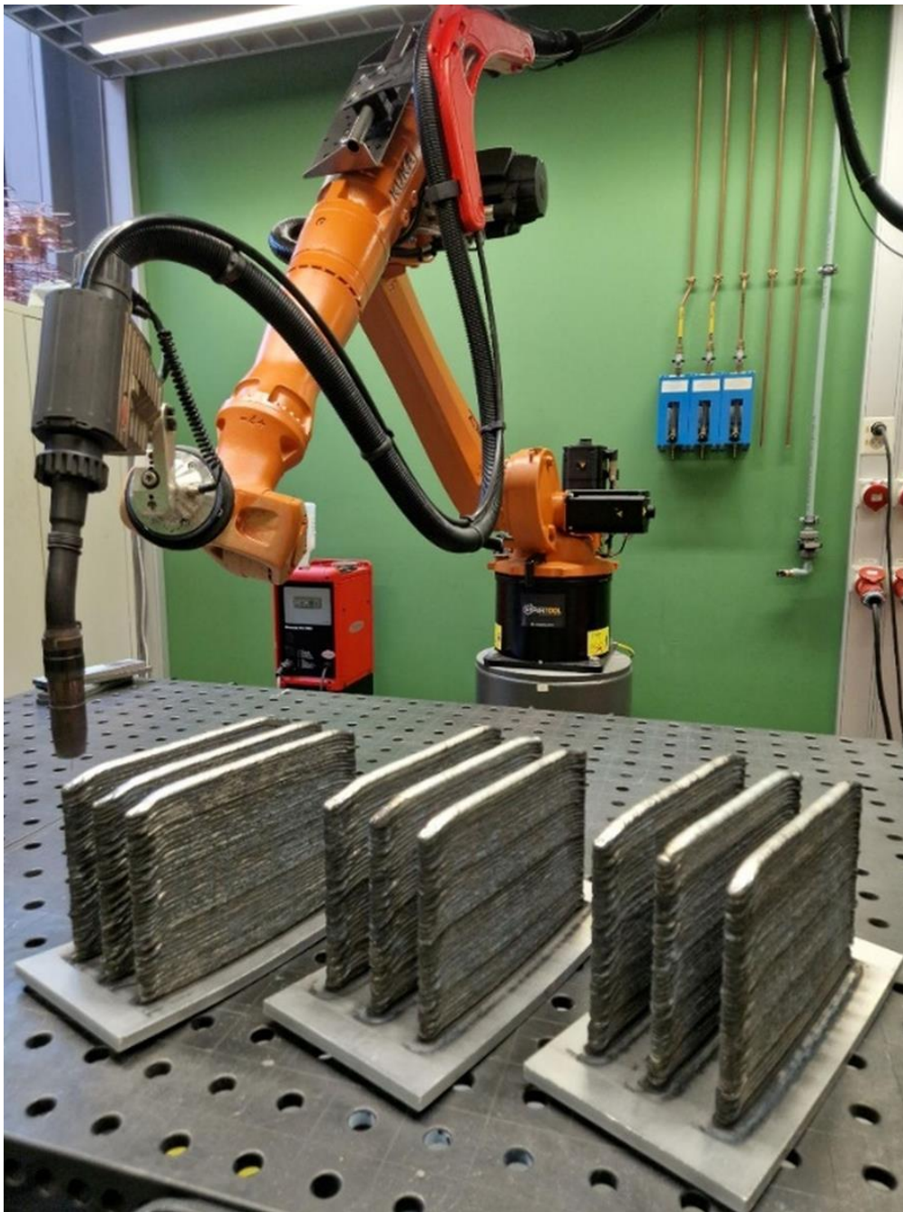
Photo 1: Pièces en aluminium dans l'alliage ER 5183 fabriquées par le WAAM, pour la recherche mécanique et métallurgique
