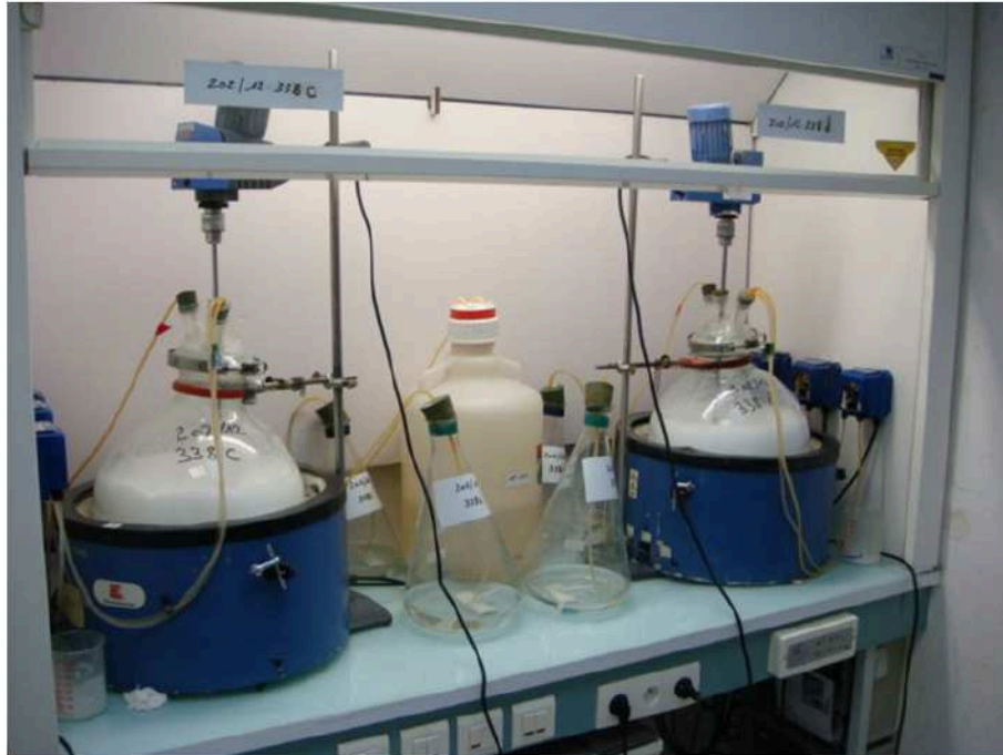
Figure 5 : Synthèse de la poudre de \beta -TCP, les réactifs de départ \text{Ca}(\text{NO}_3)_2 et \text{H}_3\text{PO}_4 sont chauffés en présence d'ammoniaque (Document Kasios).
