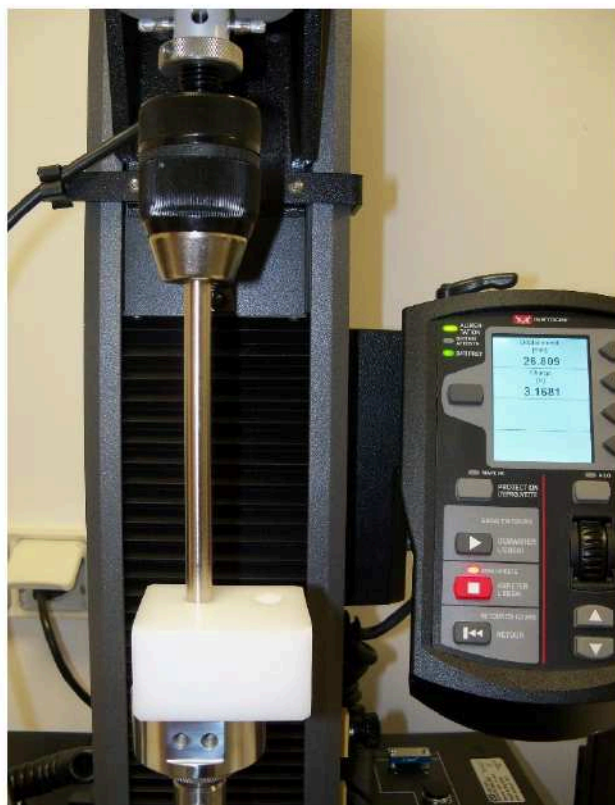
Figure 25 : Appareil de compression Instron, le poinçon écrase les granules empilés dans le support d'analyse.
