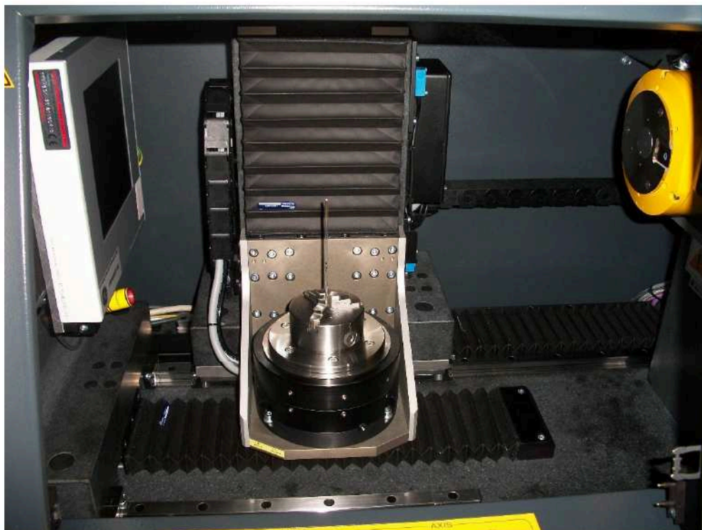
Figure 18 : Vue de l'intérieur du nanoCT : la tige de verre avec le granule de \beta -TCP est maintenue dans le mandrin, le tube cathodique est à droite et le détecteur à gauche.
