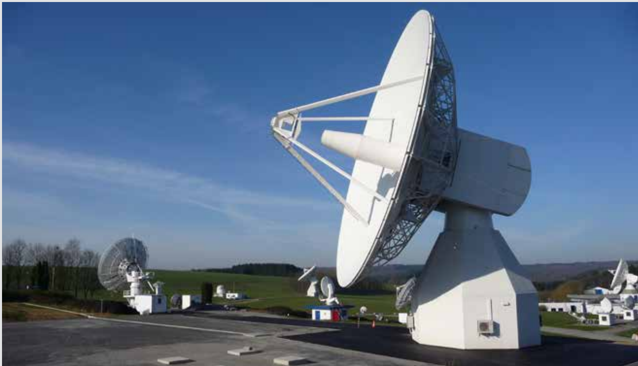
Deze grote antenne wordt gebruikt om de Galileo-satellieten te testen. © ESA/C. Lezy, CC BY-SA 3.0 IGO
