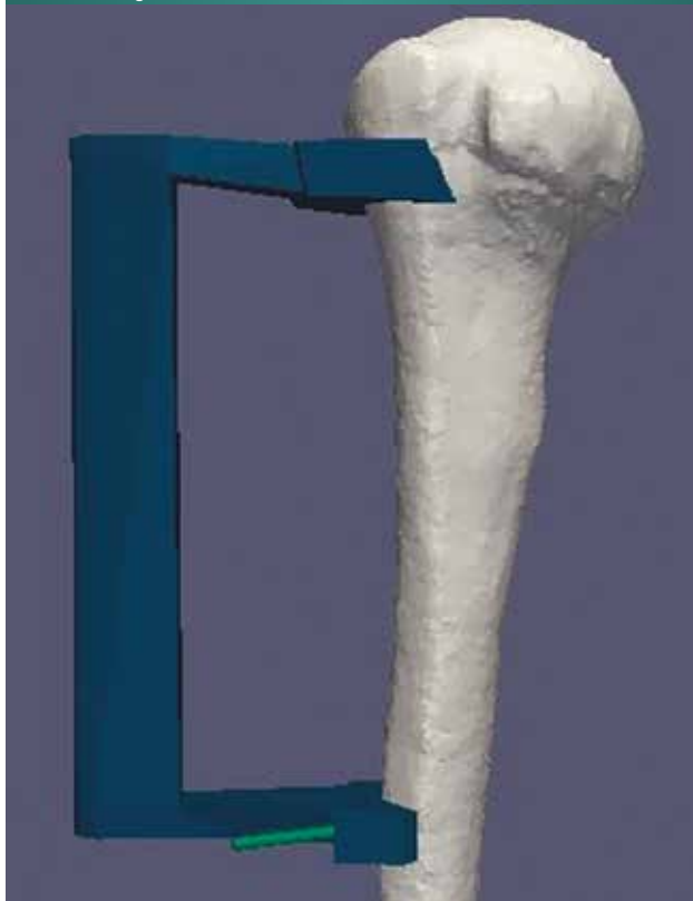
Figuur 4: Virtueel ontwerp van het PSI dat rekening houdt met de vereiste marges.
