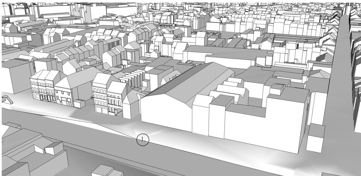
Figure 55. Combinaison du modèle UrbIS-Adm 3D – avec ajout partiel du dessin des façades – et du modèle numérique de terrain de Bruxelles UrbIS-DTM, pour un front de rue au quai de l'Industrie à Molenbeek-Saint-Jean (situation 2016). Dessin de l'auteur (2017). Source : https://cirb.brussels .
