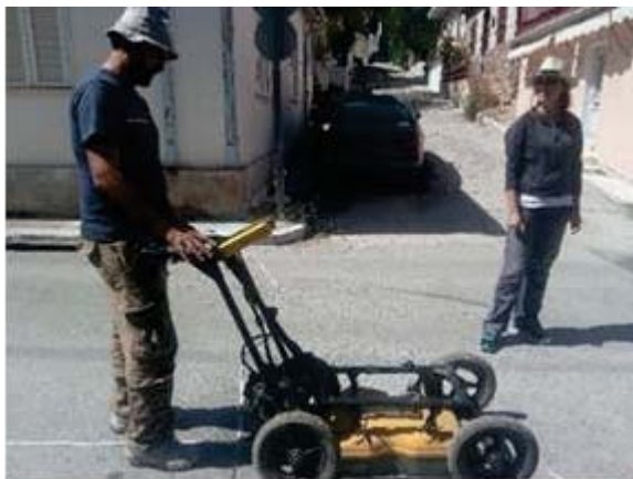
Εικόνα 3. Η μονάδα NOGGIN GPR Smart Cart Plus με κεραία των 250MHz που χρησιμοποιήθηκαν στις έρευνες στην Ζάκυνθο.
